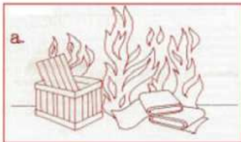
Fuegos de materiales sólidos cuya combustión se produce con formación de brasa.
