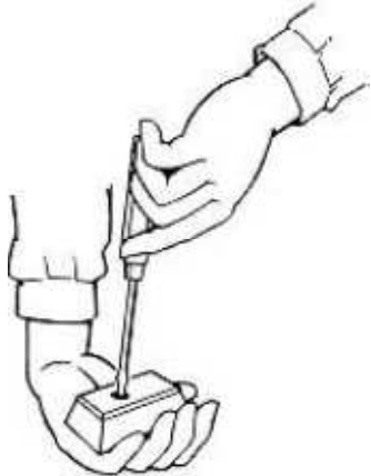
Sujeción incorrecta de una pieza a atornillar
